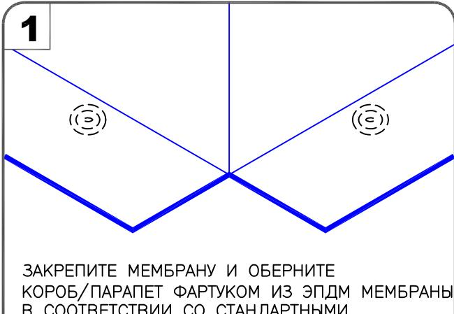
ЗАКРЕПИТЕ МЕМБРАНУ И ОБЕРНИТЕ КОРОБ/ПАРАПЕТ ФАРТУКОМ ИЗ ЭПДМ МЕМБРАНЫ В СООТВЕТСТВИИ СО СТАНДАРТНЫМИ ПРОЦЕДУРАМИ, ИСПОЛЬЗУЯ МОНТАЖНЫЙ КЛЕЙ И ШОВНУЮ ЛЕНТУ SecurTAPE.
