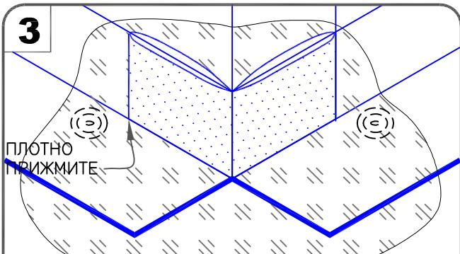
ПОСЛЕ НАНЕСЕНИЯ ПРАЙМЕРА, УДАЛИТЕ И СНОВА ПРИЛОЖИТЕ ЗАЩИТНУЮ ПЛЕНКУ. СОГНИТЕ ПОПОЛАМ ВЫРЕЗАННУЮ ЗАГОТОВКУ ИЗ ЭЛАСТОФОРМА, РАСПОЛОЖИТЕ ЗАКРУГЛЕННУЮ ЧАСТЬ БЛИЖЕ К СЕБЕ, РАСПОЛОЖИТЕ ПО ЦЕНТРУ УГЛА И ПЛОТНО ПРИЖМИТЕ К ГОРИЗОНТАЛЬНОЙ ПОВЕРХНОСТИ.
