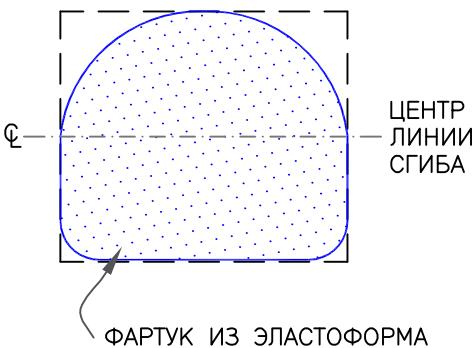
ВЫРЕЖЬТЕ ИЗ ЭЛАСТОФОРМА ПРЯМОУГОЛЬНИК РАЗМЕРОМ 229 x 229 мм. И ЗАКРУГЛИТЕ КРАЯ КАК ПОКАЗАНО НА РИСУНКЕ.
