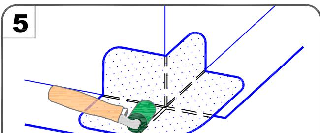
ПОСЛЕ УСТАНОВКИ, ПЛОТНО ПРОКАТАЙТЕ УГОЛ ПРИКАТОЧНЫМ РОЛИКОМ ШИРИНОЙ 50 мм. ОСОБОЕ ВНИМАНИЕ УДЕЛИТЕ УГОЛОВОМУ ПЕРЕХОДУ И КРАЯМ УСТАНОВЛЕННОГО УГЛА.
