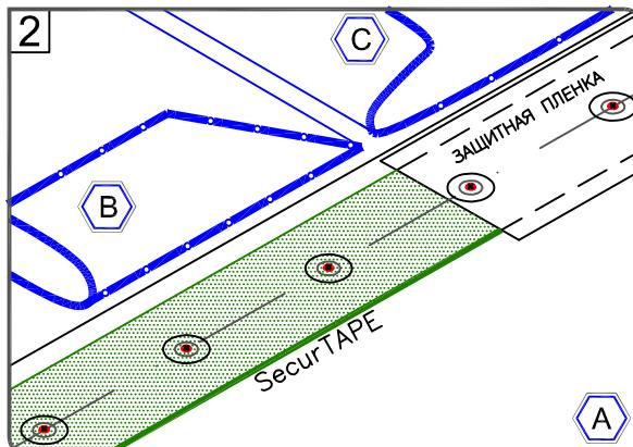
ОТОГНИТЕ ПОЛОТНА МЕМБРАНЫ КАК ПОКАЗАНО НА РИСУНКЕ. НАНЕСИТЕ ПРАЙМЕР ЭПДМ НА ОБЕ ПОВЕРХНОСТИ И ДАЙТЕ ПОДСОХНУТЬ ДО СОСТОЯНИЯ МИНИМАЛЬНОЙ ПРИЛИПАЕМОСТИ. УЛОЖИТЕ ШОВНУЮ ЛЕНТУ ВДОЛЬ ЛИНИИ РАЗМЕТКИ
