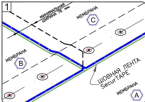
РАСПОЛОЖИТЕ СМЕЖНЫЕ ПОЛОТНА МЕМБРАНЫ С НАХЛЕСТОМ ПРИМЕРНО 180 мм. ПО ДЛЯННОЙ СТОРОНЕ И ПРИМЕРНО 76 мм. В ТОРЦЕВЫХ СОЕДИНЕНИЯХ ПОСТАВЬТЕ МЕТКИ ВОДОСТОЙКИМ МАРКЕРОМ НА НИЖНЕМ ПОЛОТНЕ МЕМБРАНЫ НА РАССТОЯНИИ ПРИМЕРНО 13 мм. ОТ КРАЯ ВЕРХНЕГО ПОЛОТНА, МОЖНО ТАК ЖЕ ИСПОЛЬЗОВАТЬ СИНОЮ ЗАВОДСКУЮ РАЗМЕТКУ.
