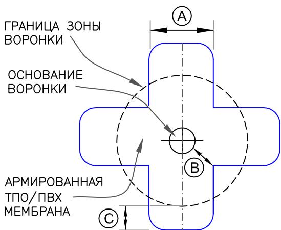
ВЫРЕЖЬТЕ ДЕТАЛЬ ИЗ АРМИРОВАННОЙ МЕМБРАНЫ, КАК ПОКАЗАНО НА РИСУНКЕ ВЫШЕ И РАСПОЛОЖИТЕ В ЗОНЕ ГРАНИЦЫ ВОРОНКИ. СТОРОНЫ МЕМБРАНЫ ДОЛЖНЫ ВЫХОДИТЬ ЗА ГРАНИЦУ ВОРОНКИ ПРИМЕРНО НА 152 мм. КРАЯ ВЫРЕЗАННОЙ ДЕТАЛИ НЕОБХОДИМО ЗАКРУГЛИТЬ.
