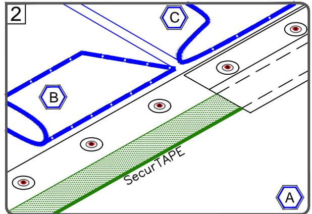
ОТОГНИТЕ ПОЛОТНА МЕМБРАНЫ КАК ПОКАЗАНО НА РИСУНКЕ. НАНЕСИТЕ ПРАЙМЕР ЭПДМ НА ОБЕ ПОВЕРХНОСТИ И ДАЙТЕ ПОДСОХНУТЬ ДО СОСТОЯНИЯ МИНИМАЛЬНОЙ ПРИЛИПАЕМОСТИ. УЛОЖИТЕ ШОВНУЮ ЛЕНТУ ВДОЛЬ ЛИНИИ РАЗМЕТКИ.
