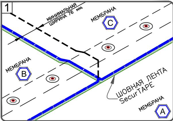
РАСПОЛОЖИТЕ СМЕЖНЫЕ ПОЛОТНА МЕМБРАНЫ С НАХЛЕСТОМ ПРИМЕРНО 140 мм. ПО ДЛИННОЙ СТОРОНЕ И ПРИМЕРНО 76 мм. В ТОРЦЕВЫХ СОЕДИНЕНИЯХ ПОСТАВЬТЕ МЕТКИ ВОДОСТОЙКИМ МАРКЕРОМ НА НИЖНЕМ ПОЛОТНЕ МЕМБРАНЫ НА РАССТОЯНИИ ПРИМЕРНО 13 мм. ОТ КРАЯ ВЕРХНЕГО ПОЛОТНА, МОЖНО ТАК ЖЕ ИСПОЛЬЗОВАТЬ СИНИЮ ЗАВОДСКУЮ РАЗМЕТКУ.
