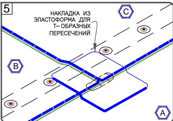
УСТАНОВИТЕ НАКЛАДКУ ИЗ ЭЛАСТОФОРМА ДЛЯ Т-ОБРАЗНЫХ ПЕРЕСЕЧЕНИЙ НА Т-ОБРАЗНЫЙ СТЫК ПОЛОТЕН, КАК ПОКАЗАНО НА РИСУНКЕ. РАЗМЕР НАКЛАДКИ ПРИМЕРНО 150 x 150 мм.
